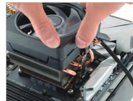
4 両側のフックをツメにかけたらロックレバーを180°反対側に倒します
