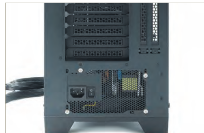
3 電源ユニットに付属するインチネジを使用し、背面から一致するネジ穴を確認して固定。ATX規格の場合は、4箇所ネジ留めされます
