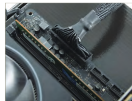
1 | 基本パーツを取り付けたマザーボードを絶縁体(マザーボードが入っていた化粧箱など)の上に置き、メイン電源ケーブル(ATX24ピンまたは20+4ピン)を接続
