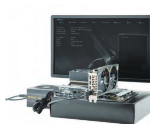
7 | PCが問題なく起動したら、素早く「Delete」キー、または「F2」キーを押して「UEFI BIOS」を立ち上げ、CPUやメモリーなどのパーツ類が正しく認識できているか、ファンの回転数、CPUの温度に異常がないか確認します
