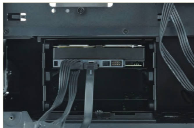
最後にSATAケーブルをHDDに接続します。コネクタは押し間違えないように、データ・電源でそれぞれ形状が異なるL字になっています
