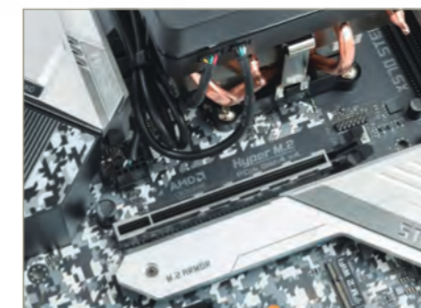
3 | グラフィックスカードは最上段のPCI-Express(x16)スロットに装着してください
