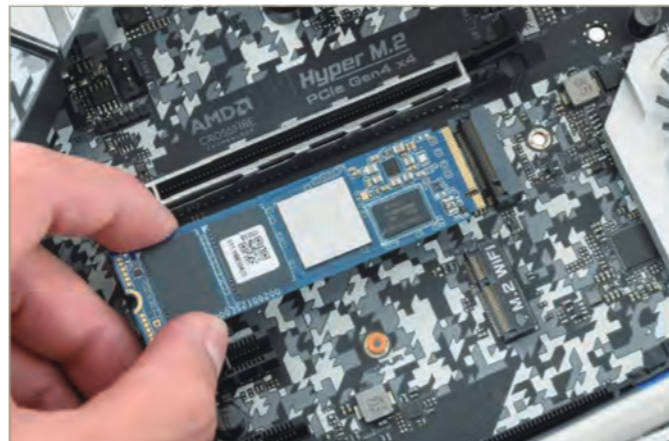
1 | SSDにある切り欠きとM.2スロットの突起部分をあわせ、SSDをM.2スロットに斜めに差し込みます
