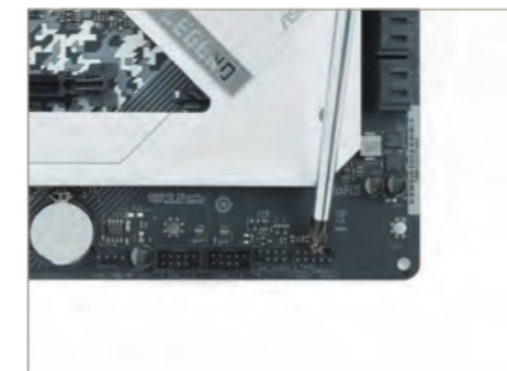
6 | マザーボード上に電源スイッチがない場合は、ドライバなどで直接ピンヘッダをショートさせて電源を投入します
