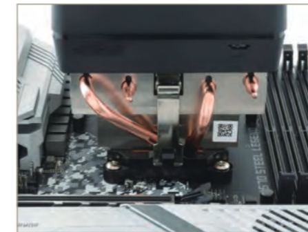
2 PCI-Expressスロット側のフックをリテンション中央にあるツメに引っ掛けます
