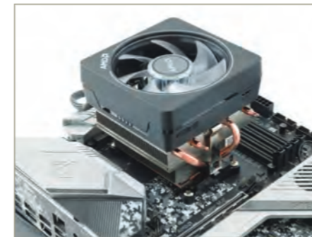
1 作業のしやすさを考慮し、ロックレバーがPCI-Expressスロットの反対側になるように、CPUクーラーをCPUの上に乗せます
