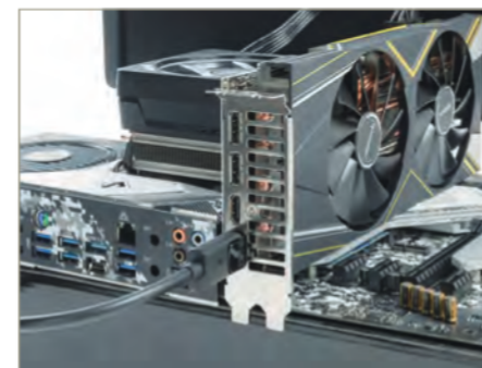
4 | 液晶ディスプレイとグラフィックスカードをディスプレイケーブルで接続します
