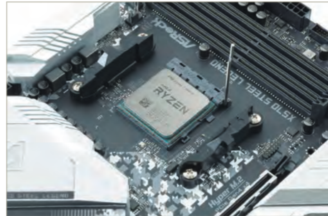
4 最初に引き起こしたCPUソケットのレバーを元の位置に戻してCPUをロックしましょう
