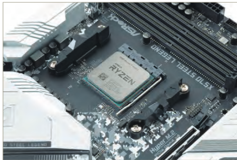
5 ソケットの横にある突起の下までゆっくりとレバーを押し込むことでロックが完了します。この時、ソケットの穴にCPUのピンが押し付けられるためレバーに若干の抵抗を感じますが、スッと収まります
