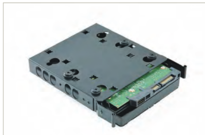
PCケースによって仕様は異なりますが、今回は専用のトレイを利用して組み込むスタイル。最初にHDDを付属のネジでトレイに装着します
