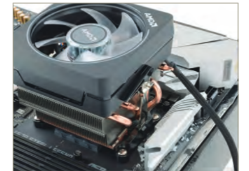
3 ロックレバーがある反対側のフックもリテンション中央にあるツメに引っ掛けます
