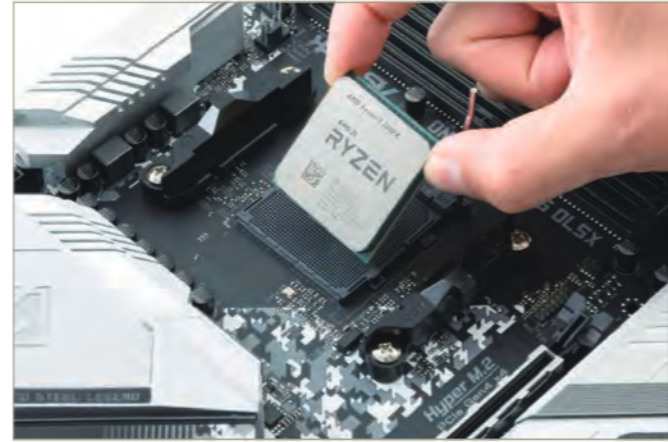
2 CPU裏面のピン(接点)を直接触れないように親指と人差し指で掴むように持ち、CPUをソケットに乗せます
