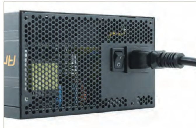
1 電源が入らない場合は、まず電源ユニットのスイッチがON(右画像)になっているか確認しましょう。また電源ケーブルがしっかり接続されているかも合わせてチェックしてください
