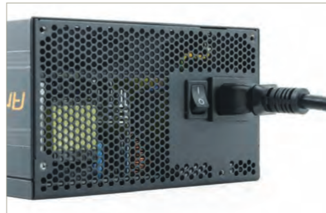
1 電源が入らない場合は、まず電源ユニットのスイッチがON(右画像)になっているか確認しましょう。また電源ケーブルがしっかり接続されているかも合わせてチェックしてください
