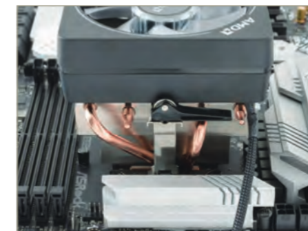
5 ロックレバーがしっかりと水平になっていることを確認してください。これでCPUクーラーの固定は完了です
