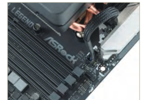
6 最後にCPUクーラーのファンケーブルを、マザーボード上のCPUクーラー用コネクタに接続します
