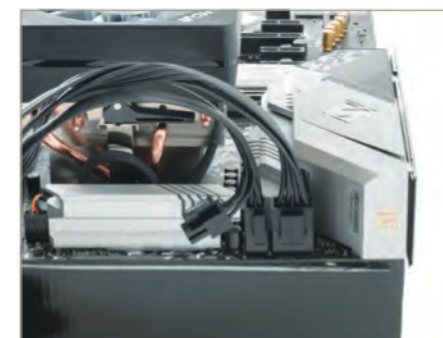
2 | 次にATX 12V/CPU用電源ケーブル(今回は8+4pin両方)を接続します
