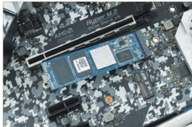
2 | SSDを水平になるように覆かせて、マザーボードに付属するM.2 SSD固定用ネジを使いスペーサーに固定すれば作業は完了です
