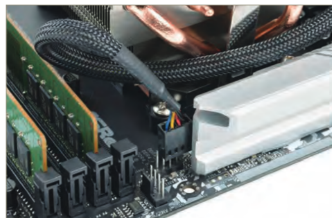
3 CPUファンエラーが表示される場合や、BIOSでCPUの温度が異常に高い場合は、CPUクーラーのファンコネクタが接続されているか確認します
