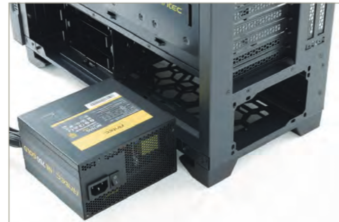
1 現行のPCケースで主流となっている、ボトムマウントスタイル。電源ユニットを側面からインストール、搭載スペースに設置します
