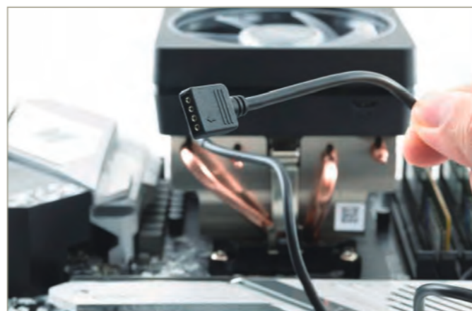
4ピンコネクタを備えるRGB LEDケーブル(左)と、3ピン/9ピンコネクタを備えるUSBケーブル(右)の2本が付属。なお今回はRGB LEDケーブルを使用します
