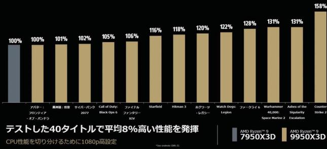
40のゲームにおけるRyzen 9 7950X3DとRyzen 9 9950X3Dのフレームレート比較 (1080p/高画質設定)では平均8%の性能向上を確認
