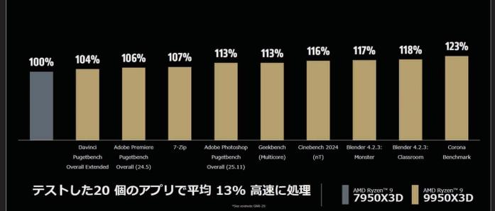
クリエイター向けのアプリケーション20種類によるRyzen 9 7950X3DとRyzen 9 9950X3Dの性能比較では平均13%向上という結果。Zen 4からZen 5へパワーアップしたアーキテクチャ、さらにクロック上昇の差がしっかりと出ている
