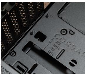
マザーボードは、PCケースのスペーサーの上に載せて固定する。ATX規格は10箇所で固定するが、本構成では1つ足りなかつたので、追加で、追加1つ足りる。
