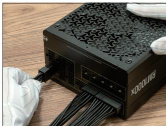
用意した3種類、5本の電源ケーブルを電源ユニットに挿し込む。挿し込みが甘いと動作不良の要因となる。
