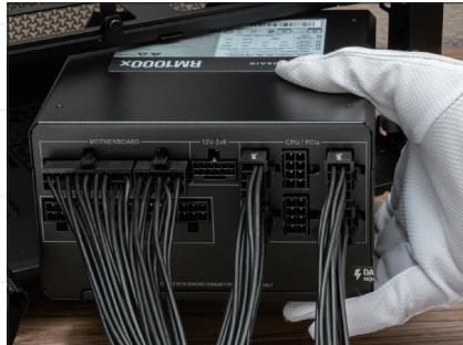
本構成のPCケースを含め、多くはPCケースボトムに電源ユニット搭載スペースが用意されている。電源ユニットの内蔵ファンが、下向きになるように取り付けよう。
