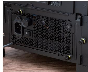
PCケース背面の固定ネジ位置を確認しながら、PCケースの奥まで入れる。本構成では付属のインチネジ2本と、ケース取り付け済みのネジ2本を均等に締めて固定する。
