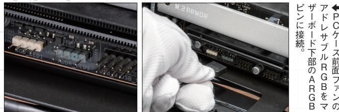
◀ PCケース前面ファンアドレスブルRGBをマザーボード下部のARGBピンに接続。
