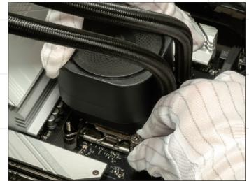
→↑チューブがメモリスロット側に位置するよう、水冷ヘッドを standards off に置こう。付属のネジを手で回して仮留めしよう。
