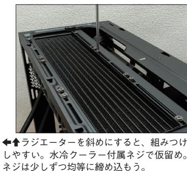
→↑ラジエーターを斜めにすると、組みつけしやすい。水冷クーラー付属ネジで仮留め。ネジは少しづつ均等に締め込もう。
