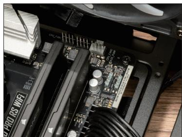
→マザーボード右上のCPUクーラー向けPWMファン電源と、ARGBコネクタに接続する。
