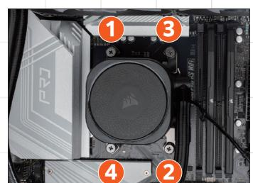
→↑水冷ヘッドの設置、チューブのよじれを確認。大丈夫なら、均等に圧がかかるように、対角線上のネジを少しづつ締め込もう。
