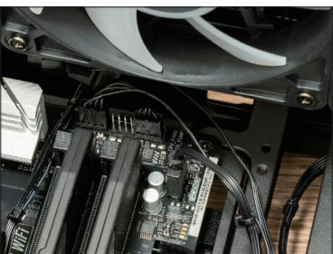
→ラジエーターのポンプと、ARGB水冷ヘッドのポンプと、ARGBケーブルを接続しよう。
