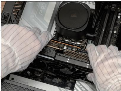
◀ビデオカードのファンカバーに両手の親指を添えて、真っ直ぐにビデオカードを押し込む。挿し込まれると、拡張スロットに備わっているロックが、自然にかかる。
