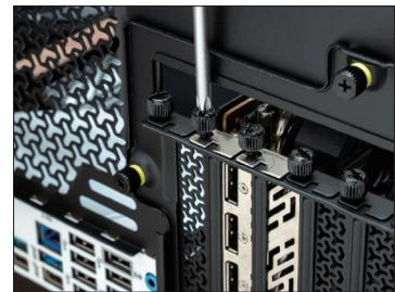
◀▶ビデオカードが斜めにならないか、拡張スロットへの挿しこみが甘くないか確認。問題なければ、ネジを使用してビデオカードを、しっかりと固定する。
