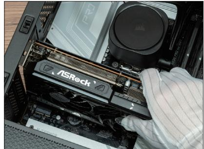
◀拡張スロットとビデオカードの端子位置を確かめつつ、ビデオカードを垂直に軽く、押し込む。出力端子側を下に斜めに入れると、スムーズに作業できる。
