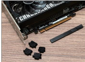
◀▶ビデオカード取り付け位置の拡張スロットカバーを取り外す。また、ビデオカードの接続、外部出力端子部に保護カバーが、装着されている場合は取り外す。
