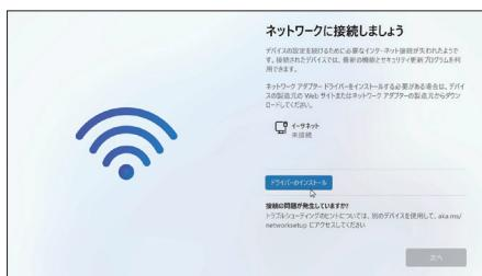
➡Windows 11は、インストール時にネットワーク接続が必要となる。標準ドライバーで動作しない有線/無線LANの場合、手動でドライバーを導入する必要がある。
