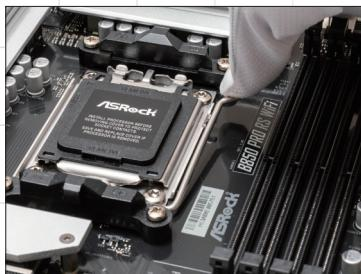
◀CPUソケット横のレバーを横にずらして、上に持ち上げる。なお、CPUソケットが標準で備えている保護カバーは、そのままに作業を行って大丈夫だ。
