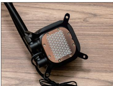
インテル用を水冷チューブの根元側から押して、取り外す。塗布されたグリスに注意しよう。
