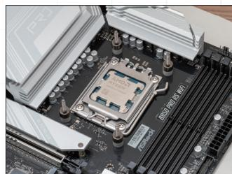
水冷ヘッドを固定するスタンドオフを取り付ければ、マザーボードの準備は完了となる。ネジの締め込み具合を確認したら、次の工程に進もう。
