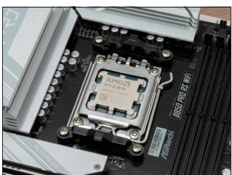
標準装備されている、CPUクーラーの取り付けブラケットを、4箇所のネジを外して、取り外そう。
