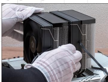
→ファンクリップを使って、ヒートシンクに固定する。片方のクリップをはめたあとに、もう片方を引っ張って固定する。1基は、メモリ固定後に作業する。
