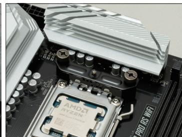
→スタンドオフを手回しで取り付け。その上にブラケットを置き、付属のナットで固定する。
