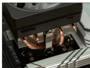
→固定金具をブラケットのフックに、はめ込みレバーを倒すだけだ。
