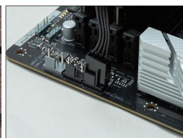
→ファンのPWMコネクタを分歧ケーブルに接続し、CPU-FAN1コネクタに挿し込む。
