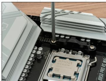
→標準装備のCPUクーラー取り付けブラケットを取り外す。4箇所のネジを外して、樹脂製ブラケットを取り外そう。外したブラケットは、保存しておこう。
