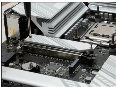
◀ M.2ソケットのヒートシンクを取り外す。基板側ヒートシンクの保護シートも外しておく。
