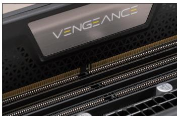
◀ 使用メモリスロットのラッチを上から押して開き、スロットとメモリ端子部の切り欠き位置を合わせて、軽く挿し込む。
