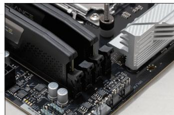
◀ マザーボードの下を持ち、メモリ上部の両端を親指で押そう。しっかりと挿し込めば、自然にラッチは閉じる。
