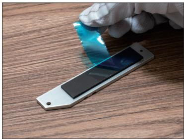
◀ 基板表面側のヒートシンク裏面に備わっている熱伝導パッドの保護シートを取り外そう。
