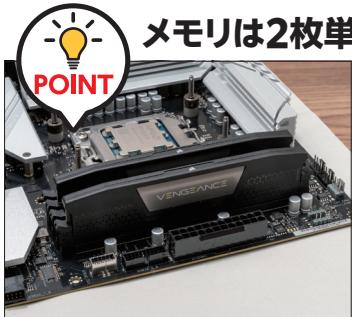
◀ 1枚でも動作するが、2枚単位で搭載した際にパフォーマンスが向上するデュアルチャンネル動作が望ましい。2枚セット品を使用しよう。
