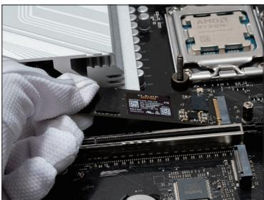
◀ 端子部とソケットの切り欠きを合わせながら、斜めに奥まで挿し込み、基板を水平に倒す。
