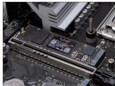
◀ 基板端の凹がスペーサーの凸に、バーを回して固定する。
